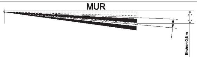
Si vous sélectionnez l'inclinaison de 3 degrés, la zone de détection se trouvera à 0,6 m du mur à 12 m de distance.
