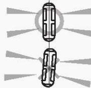
Installer le détecteur à la verticale, avec les faisceaux de détection hauts parallèles au sol. Si le détecteur est installé avec une inclinaison vers le sol, la fiabilité de détection risquera de décroître.
