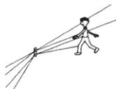
Ensuite, veiller à bien désactiver le MODE DE TEST DE DETECTION. Enfin, effectuer le test de détection près des fenêtres que le BN-80NR doit protéger, et s'assurer que l'alarme se déclenche bien. Si aucune alarme ne se déclenche lors du test de détection, les zones de détection ne sont pas correctement couvertes par le faisceau dans le sens horizontal. Dans ce cas, se reporter à la section 7. REGLAGE DE LA ZONE DE DETECTION et vérifier si les zones sont correctement couvertes par le faisceau.
