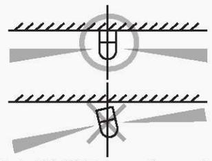
Installer le BX-80NR de manière que les faisceaux de détection soient parallèles au mur.
