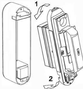
Une fois le câblage effectué entre le transmetteur et l'appareil, fixer avec 2 vis. Accrocher l'appareil sur la BOITE DORSALE et le fixer en tournant 2 vis de fixation sur l'unité du dessous.
