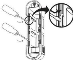
Dégager les trois ergots de chaque côté du SUPPORT DE LENTILLE en insérant la lame d'un tournevis comme indiqué ci-dessus. Séparer ensuite le SUPPORT DE LENTILLE du CAPOT AVANT en saisissant les protubérances du SUPPORT DE LENTILLE.
