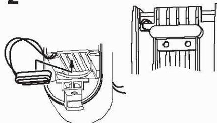
Le contact magnétique muni du câble doit être fixé sur la partie inférieure de la BOITE DORSALE.
