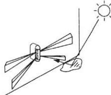
Eviter de diriger le faisceau de détection bas vers des surfaces réfléchissantes (flaques, fenêtres, etc.).
