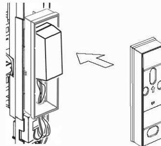
Tirer les câbles par la partie inférieure de la BASE DE PILE et les faire passer par le trou de passage de câble de l'appareil. Refermer le COMPARTIMENT DE PILE.
