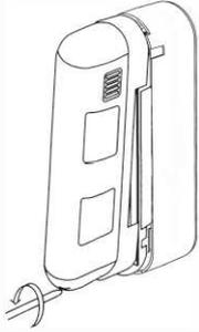
Desserrer la VIS DE FIXATION DU CAPOT et retirer le CAPOT AVANT. Ne pas toucher la surface des LENTILLES.
