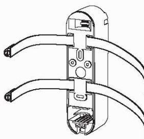
Utiliser la bande d'attache métallique pour fixer l'appareil. Attacher fermement l'appareil sur un tuyau de gouttière. (Taille des bandes d'attache max.: 20 mm de largeur / 0,5 mm d'épaisseur)
