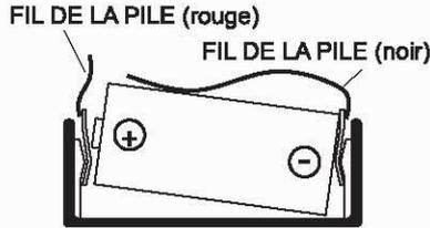
Si le BX-80NR est alimenté par la pile du transmetteur, utiliser les FILS DE PILE inclus. Appuyer sur chaque ergot du fil entre la borne de pile et le support de pile.
