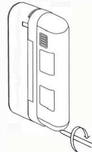
Mettre le capot en place et effectuer un test de détection. Une fois cette opération accomplie, tourner la vis de fixation sur le capot.
