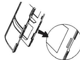
Déplacer la LENTILLE pour sélectionner l'inclinaison (0 ou 3 degrés) des faisceaux de détection, comme indiqué ci-dessus, et vérifier que la LENTILLE soit bien dégagée de l'encoche du SUPPORT DE LENTILLE.
