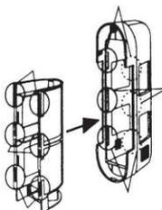
Après avoir sélectionné le réglage du faisceau de détection, remettre le SUPPORT DE LENTILLE dans le CAPOT AVANT en alignant les trois ergots (A, B et C) de chaque côté du SUPPORT DE LENTILLE sur les trois encoches (A', B' et C') du CAPOT AVANT.
