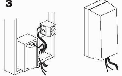
Utiliser le câble d'alarme inclus pour effectuer la connexion à la borne d'entrée d'alarme, tirer les câbles vers l'extérieur et refermer le capot.
