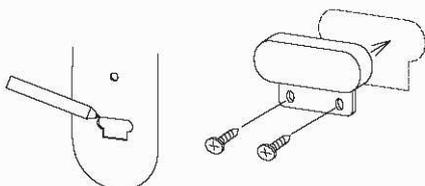
Utiliser le GABARIT DE MONTAGE inclus pour déterminer l'emplacement d'installation.
