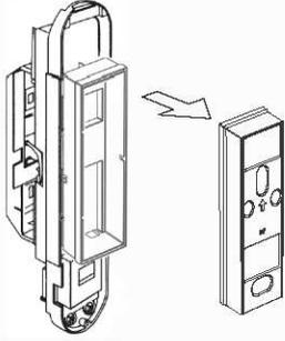
Retirer le COMPARTIMENT DE PILE de la BASE DE PILE.
