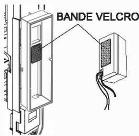
Utiliser une BANDE VELCRO pour fixer le transmetteur dans la BASE DE PILE.
